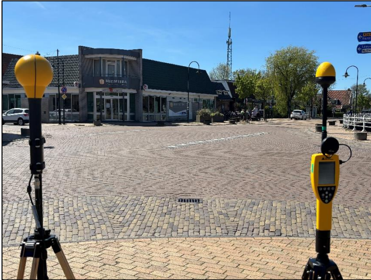
Figuur 1: Foto van de breedbandige outdoor meetopstelling.
