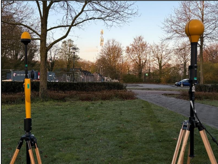
Figuur 1: Foto van de breedbandige outdoor meetopstelling.
