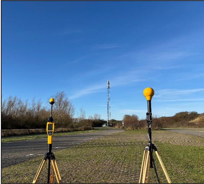
Figuur 1: Foto van de breedbandige outdoor meetopstelling.
