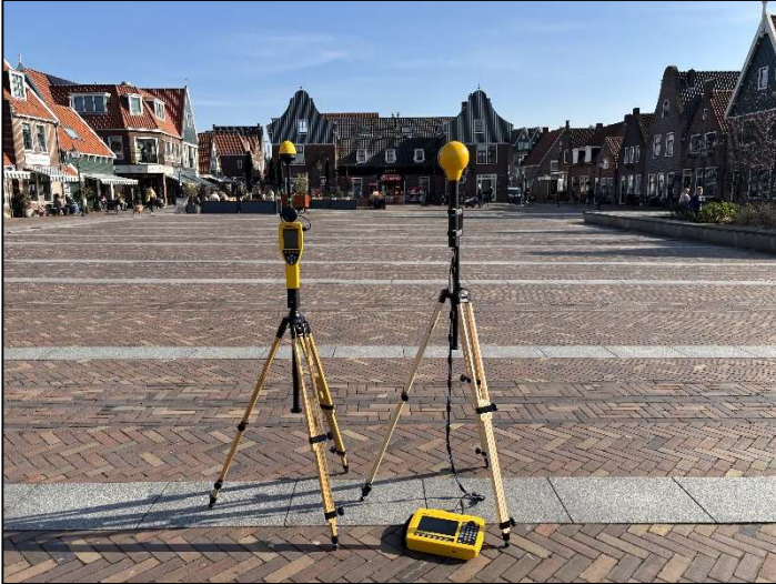
Figuur 1: Foto van de breedbandige outdoor meetopstelling.
