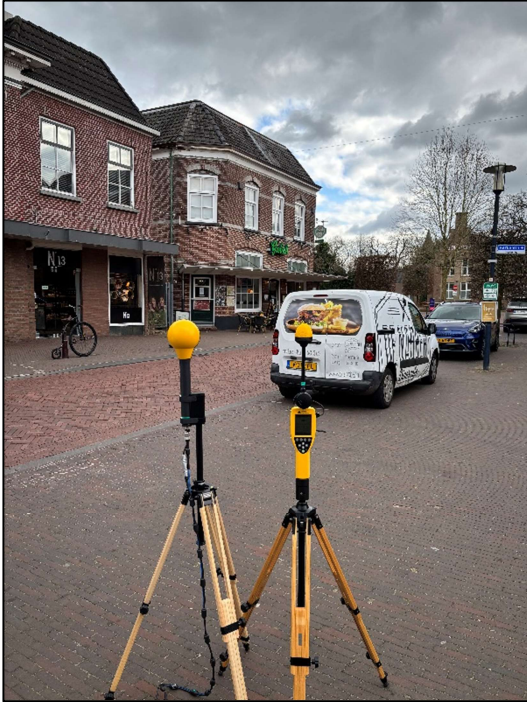
Figuur 1: Foto van de breedbandige outdoor meetopstelling.
