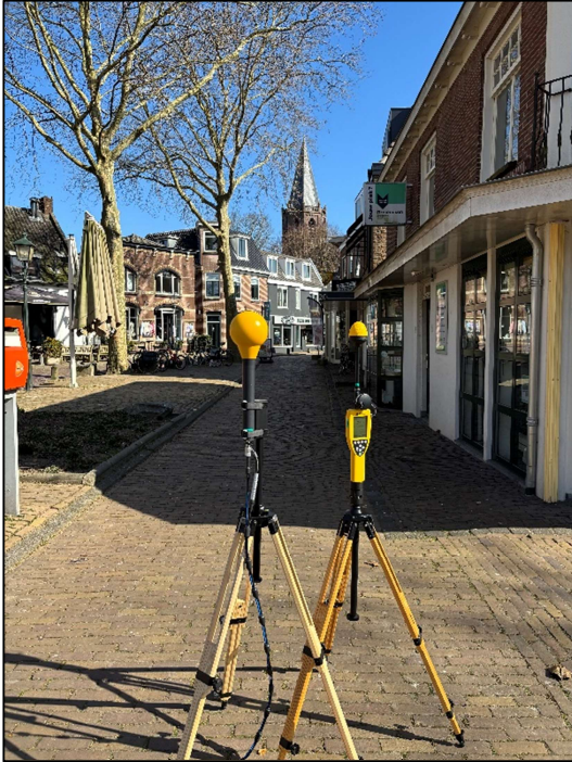
Figuur 1: Foto van de breedbandige outdoor meetopstelling.
