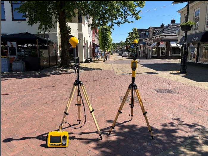
Figuur 1: Foto van de breedbandige outdoor meetopstelling.
