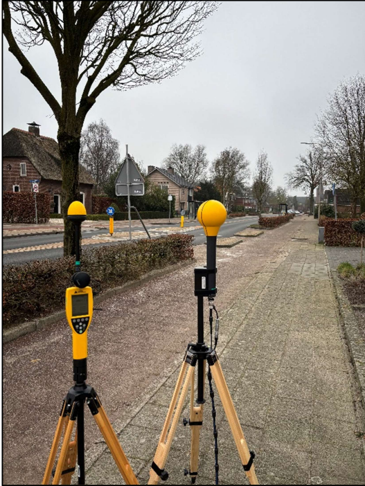
Figuur 1: Foto van de breedbandige outdoor meetopstelling.
