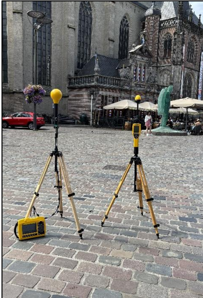
Figuur 1: Foto van de breedbandige outdoor meetopstelling.
