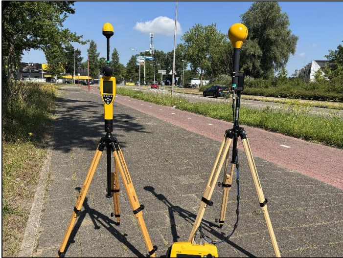
Figuur 1: Foto van de breedbandige outdoor meetopstelling.
