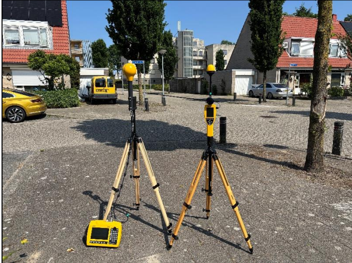
Figuur 1: Foto van de breedbandige outdoor meetopstelling.
