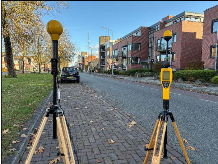
Figuur 1: Foto van de breedbandige outdoor meetopstelling.
