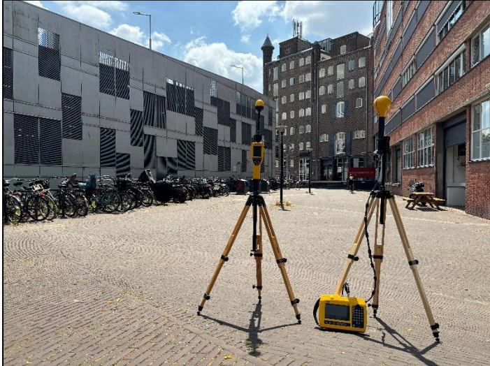
Figuur 1: Foto van de breedbandige outdoor meetopstelling.
