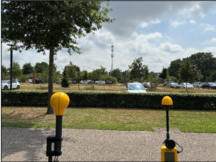
Figuur 1: Foto van de breedbandige outdoor meetopstelling.
