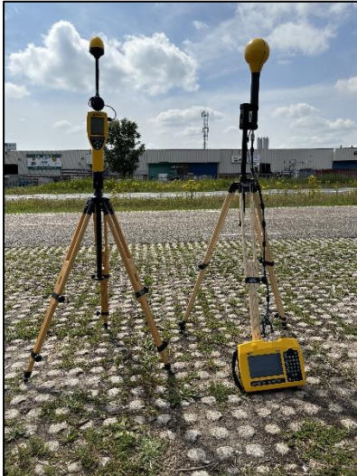
Figuur 1: Foto van de breedbandige outdoor meetopstelling.
