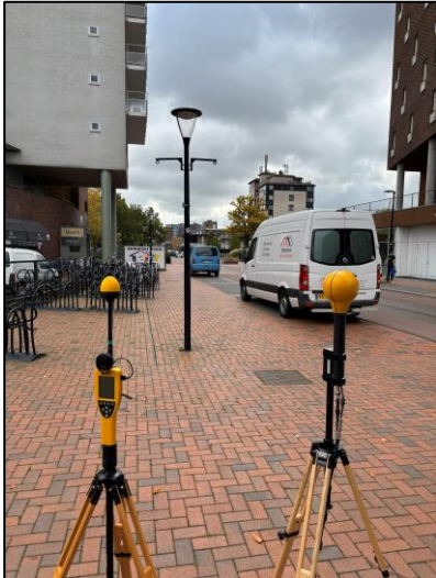
Figuur 1: Foto van de breedbandige outdoor meetopstelling.
