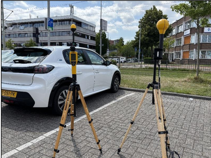
Figuur 1: Foto van de breedbandige outdoor meetopstelling.
