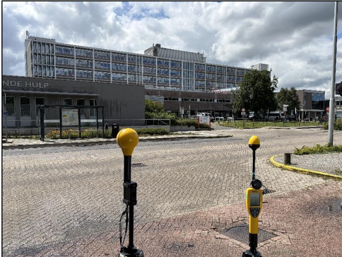
Figuur 1: Foto van de breedbandige outdoor meetopstelling.
