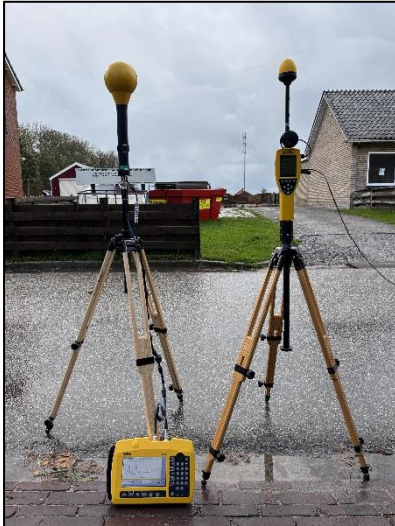
Figuur 1: Foto van de breedbandige outdoor meetopstelling.
