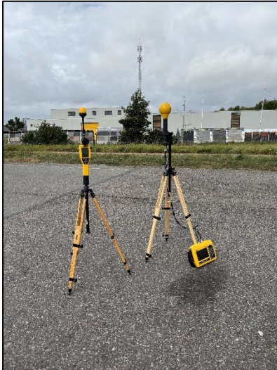
Figuur 1: Foto van de breedbandige outdoor meetopstelling.
