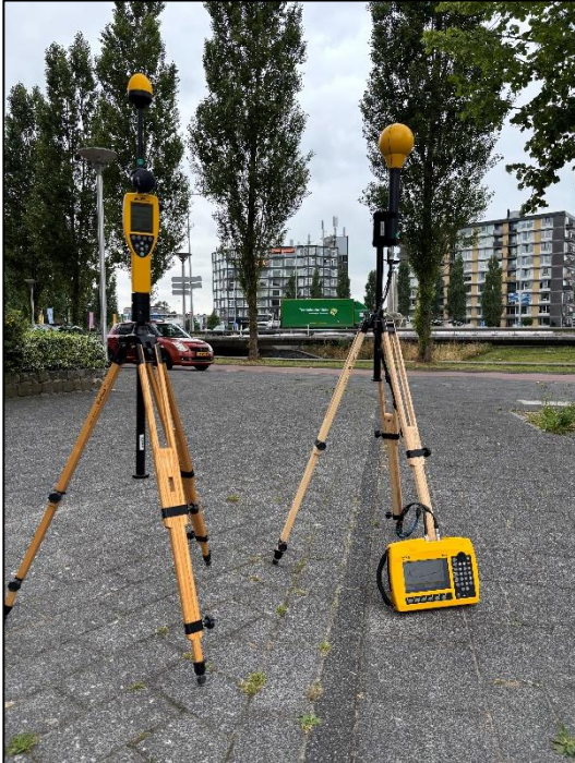
Figuur 1: Foto van de breedbandige outdoor meetopstelling.
