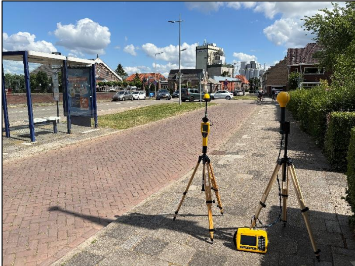
Figuur 1: Foto van de breedbandige outdoor meetopstelling.
