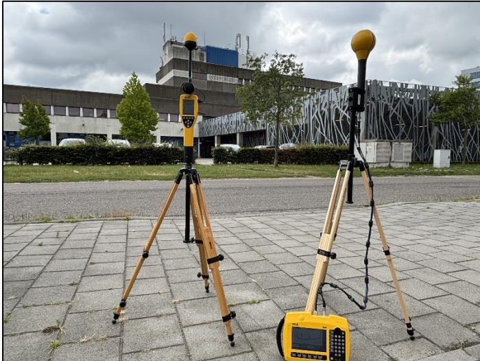
Figuur 1: Foto van de breedbandige outdoor meetopstelling.
