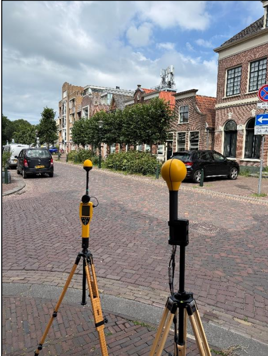
Figuur 1: Foto van de breedbandige outdoor meetopstelling.
