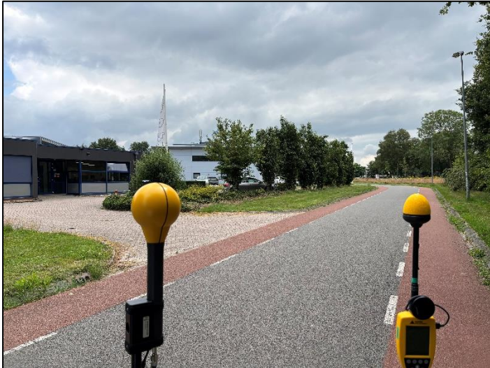
Figuur 1: Foto van de breedbandige outdoor meetopstelling.
