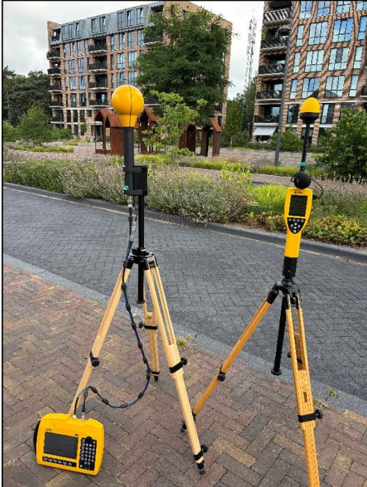
Figuur 1: Foto van de breedbandige outdoor meetopstelling.
