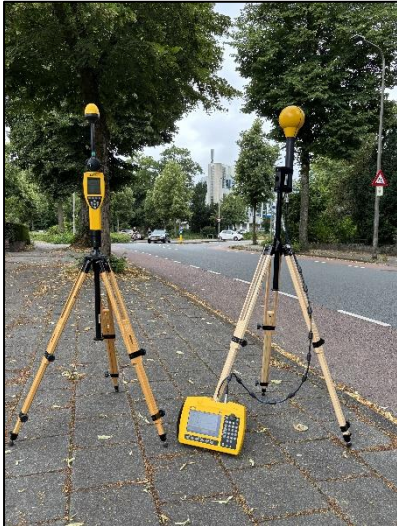
Figuur 1: Foto van de breedbandige outdoor meetopstelling.
