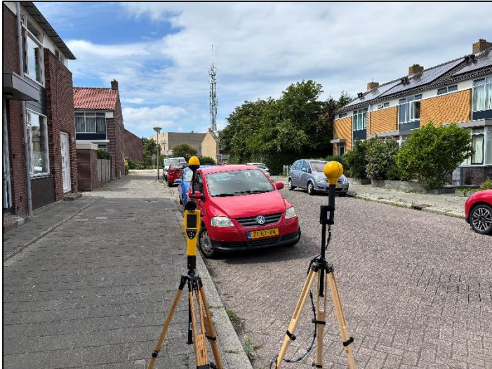
Figuur 1: Foto van de breedbandige outdoor meetopstelling.
