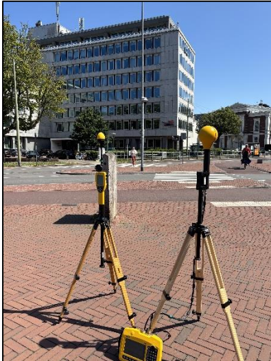
Figuur 1: Foto van de breedbandige outdoor meetopstelling.
