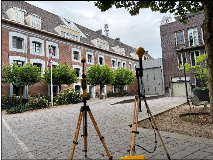
Figuur 1: Foto van de breedbandige outdoor meetopstelling.
