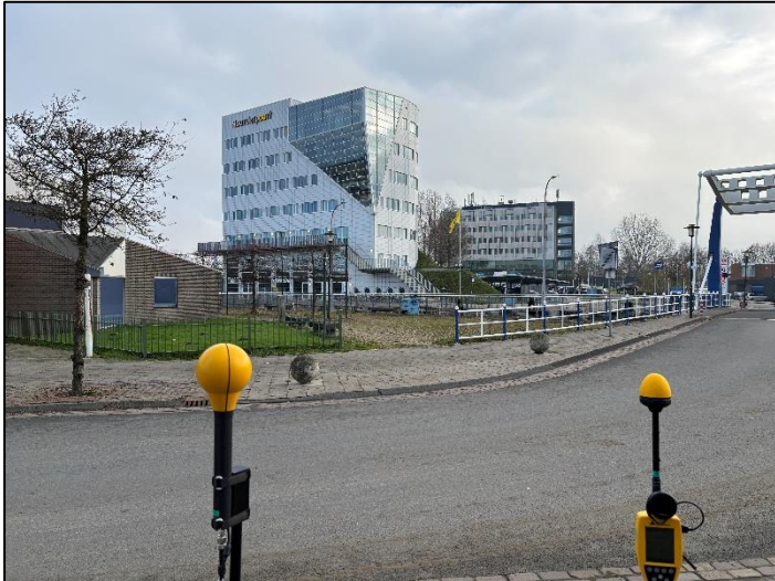
Figuur 1: Foto van de breedbandige outdoor meetopstelling.
