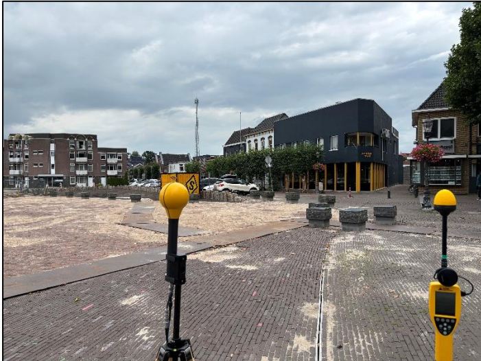
Figuur 1: Foto van de breedbandige outdoor meetopstelling.
