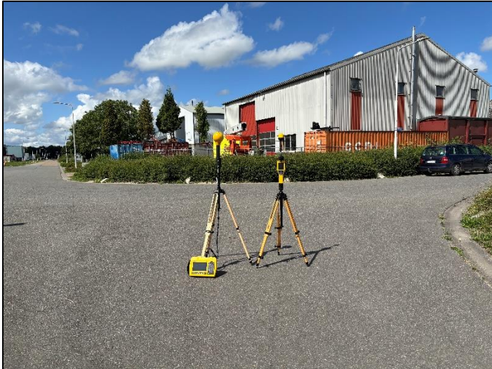
Figuur 1: Foto van de breedbandige outdoor meetopstelling.
