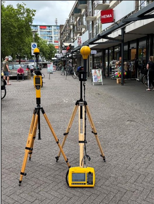
Figuur 1: Foto van de breedbandige outdoor meetopstelling.
