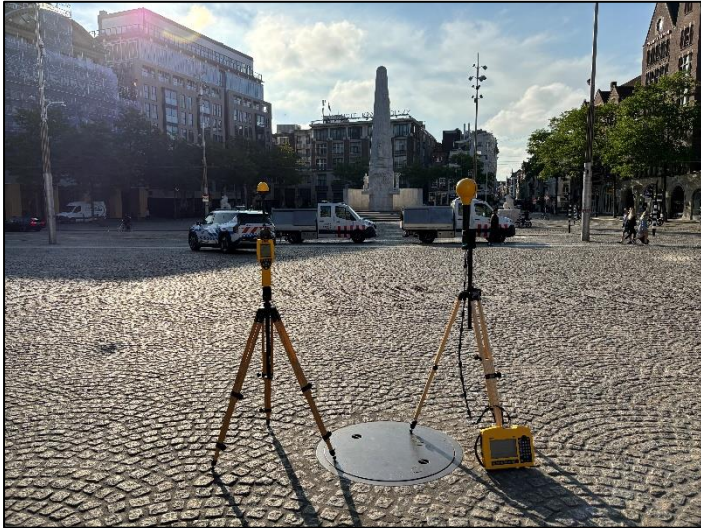
Figuur 1: Foto van de breedbandige outdoor meetopstelling.
