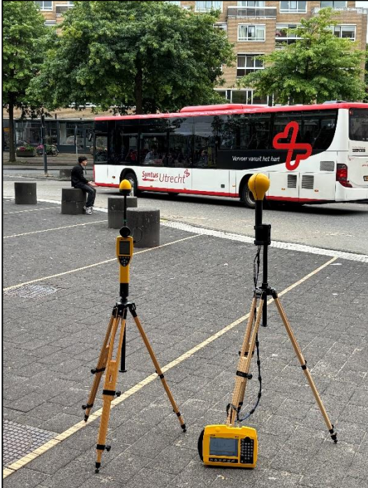
Figuur 1: Foto van de breedbandige outdoor meetopstelling.
