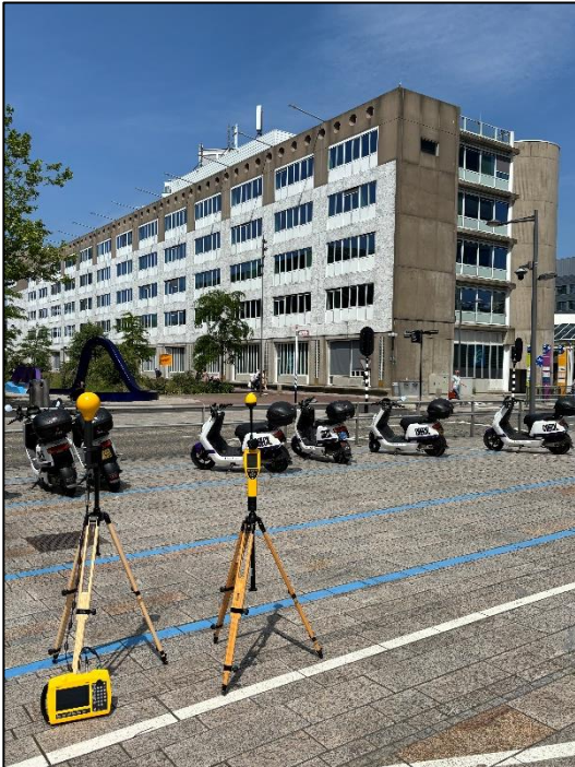
Figuur 1: Foto van de breedbandige outdoor meetopstelling.
