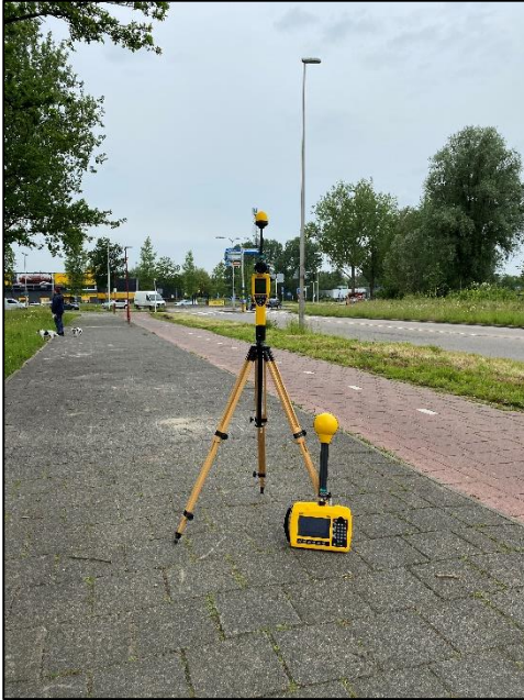
Figuur 1: Foto van de breedbandige outdoor meetopstelling
