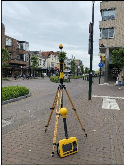
Figuur 1: Foto van de breedbandige outdoor meetopstelling
