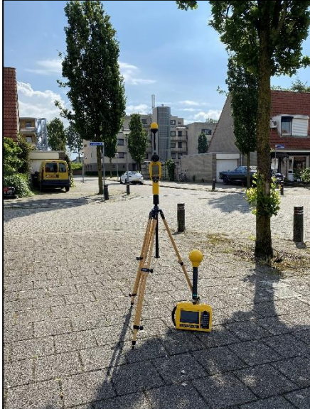
Figuur 1: Foto van de breedbandige outdoor meetopstelling
