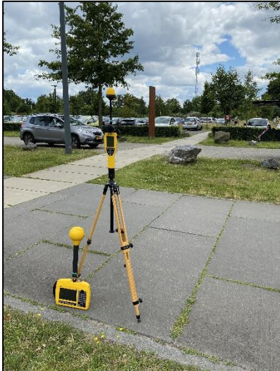
Figuur 1: Foto van de breedbandige outdoor meetopstelling
