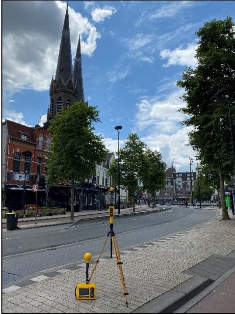
Figuur 1: Foto van de breedbandige outdoor meetopstelling
