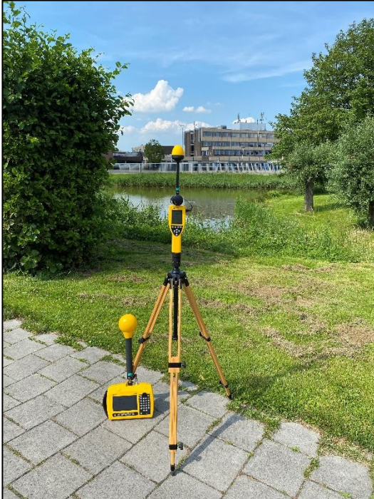
Figuur 1: Foto van de breedbandige outdoor meetopstelling
