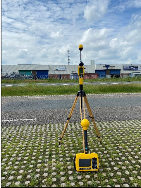
Figuur 1: Foto van de breedbandige outdoor meetopstelling
