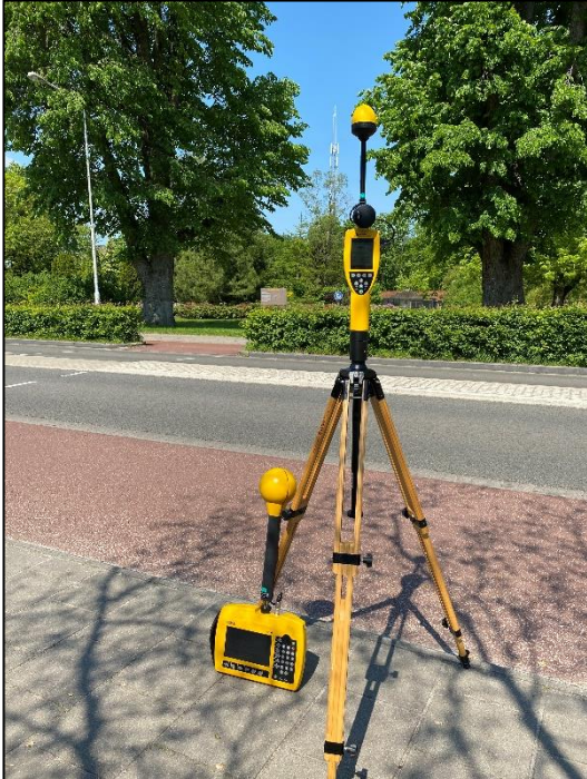
Figuur 1: Foto van de breedbandige outdoor meetopstelling
