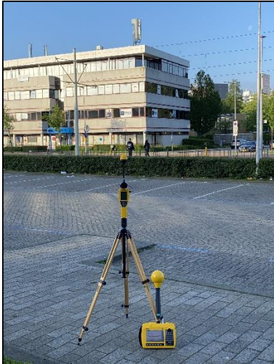
Figuur 1: Foto van de breedbandige outdoor meetopstelling
