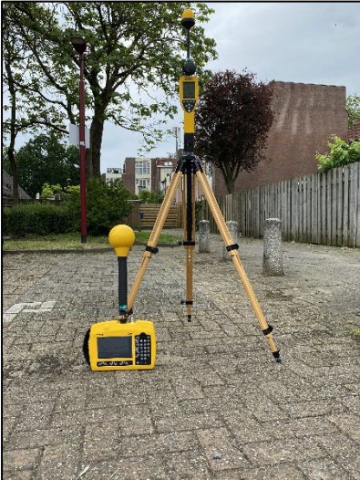
Figuur 1: Foto van de breedbandige outdoor meetopstelling
