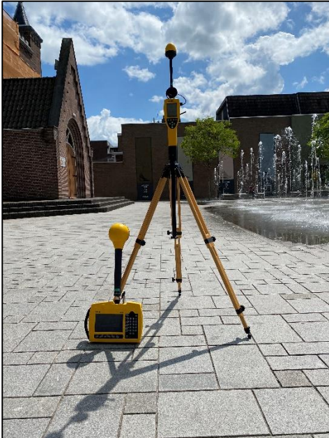
Figuur 1: Foto van de breedbandige outdoor meetopstelling
