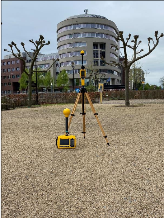
Figuur 1: Foto van de breedbandige outdoor meetopstelling
