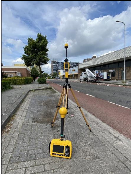
Figuur 1: Foto van de breedbandige outdoor meetopstelling
